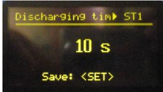
13. Ustawienie czasu rozładowania kondensatora 1st. na 10s
