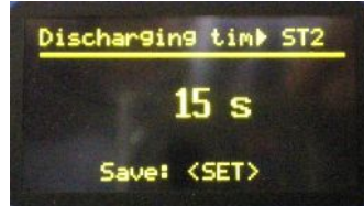
14. Ustawienie czasu rozładowania kondensatora 2st. na 15s / czas rozładowania z krokiem od 0 do 999s/. Zero dla tyrystorów.
