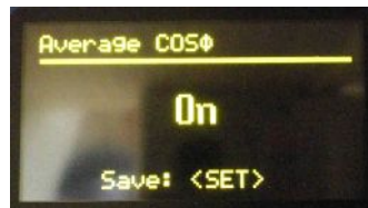
17. Ustawienie regulacji na wsp. mocy cosφ średni.
