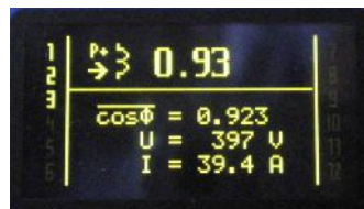
2. Ekran pomiarowy: obciążenie ind. przepływ zgodny, lewe i prawe pole ekranowe pokazuje załączone stopnie wyjściowe regulatora.
