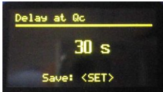
10. Ustawienie nadkompensacji na 30s Parametr może spadać -. Od 1kr/s do 30kr/s – wyzerowanie parametru powoduje odłączenie stopnia wyj. reg.
