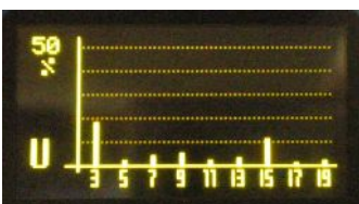
8. Skalowany ekran pomiarowy: wartości harmonicznych w napięciu Harmoniczne od 1 do 19.
